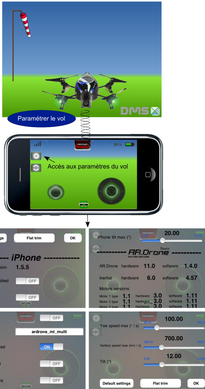
Fig. 24: Paramétrage du vol depuis la Station-Sol
