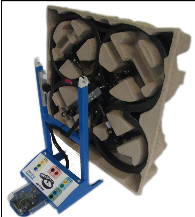
Fig. 78: Portique et croix centrale
