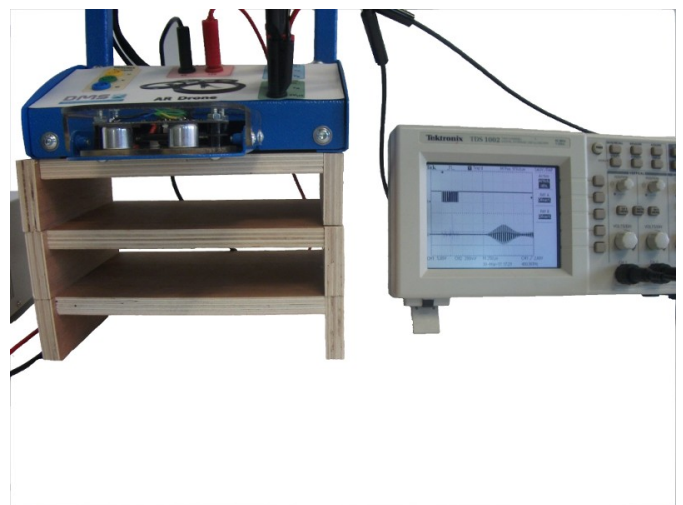
Fig. 120: Utilisation de cales de 5cm
