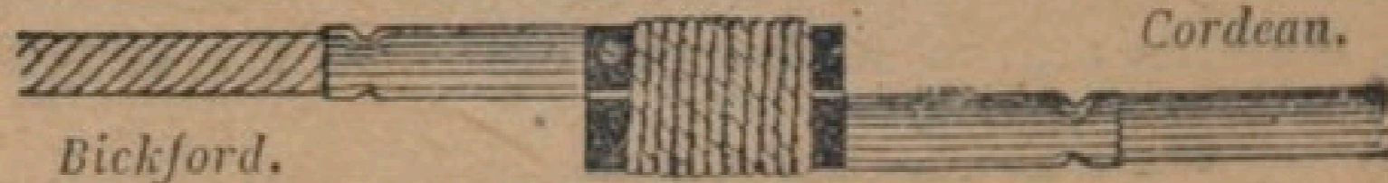
Fig. 106. — Amorçage du cordeau détonant.
