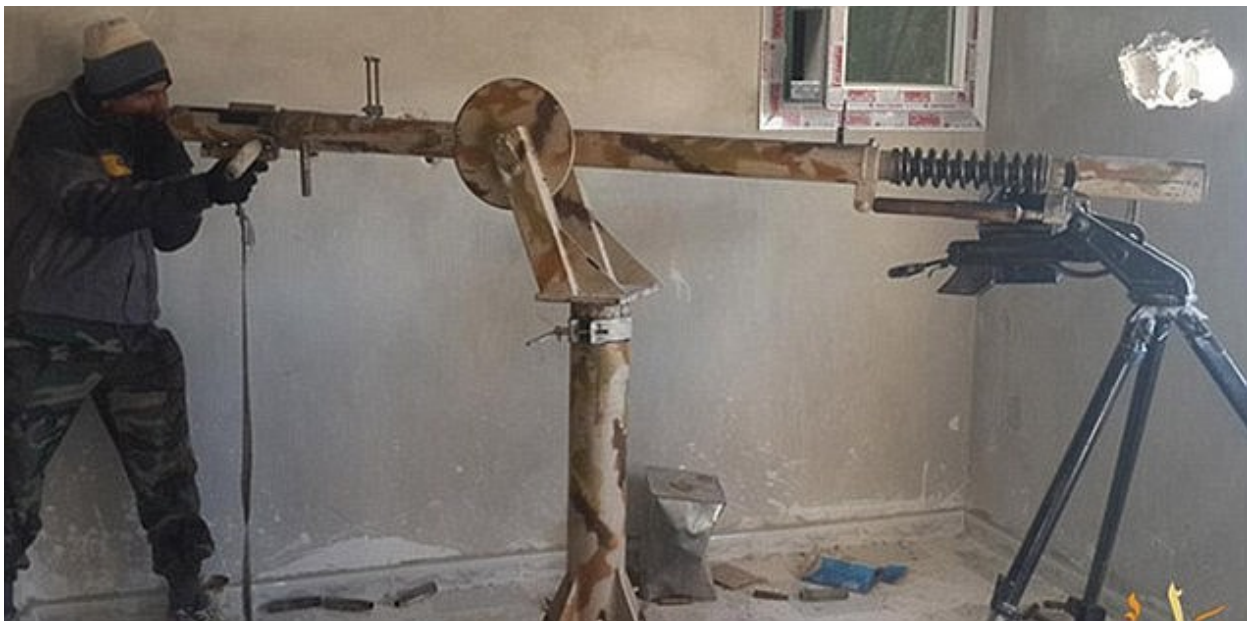
Arme antimatériel développée par l'EI et utilisée par l'EI. Si le canon est souvent présenté comme une arme de sniping, l'absence de lunette de tir et le peu de maniabilité du système (affût support + trépied) le destine plutôt à des tirs contre des retranchements installés dans des immeubles, au tir contre des mitrailleuses, des canons antiaériens ou des canons sans-recul positionnés et ne pouvant être déplacés avec célérité, contrairement aux snipers. Le calibre est vraisemblablement de 23 mm. (Photo : via réseaux sociaux)
