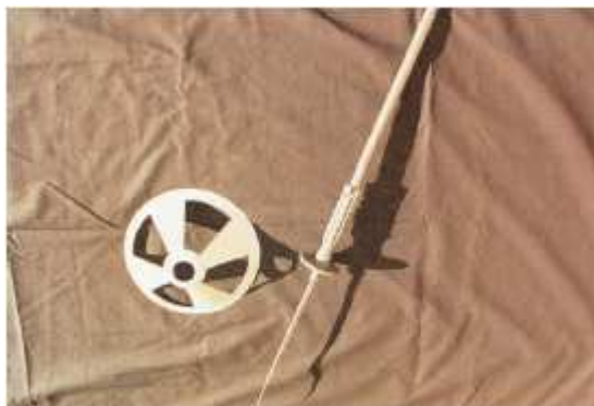
Sonde de déminage et repère de mine
