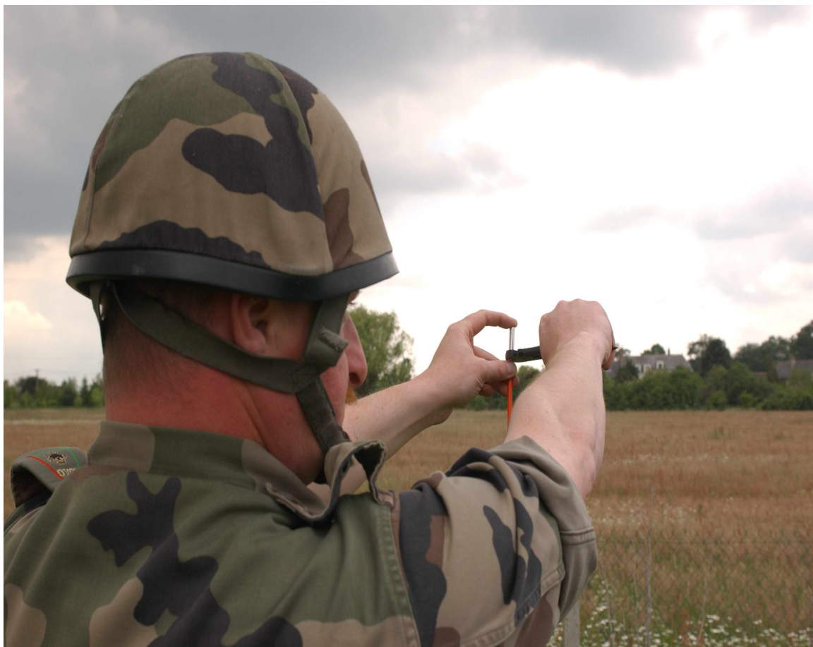
Fig. 8 – Position des mains par rapport au visage pour le sertissage d'un détonateur. Avant de serrer, il convient de tourner le visage vers la droite pour protéger les yeux.
